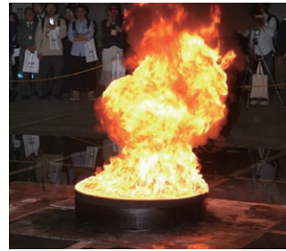
軽油の燃焼実験 [消防研究センター]
